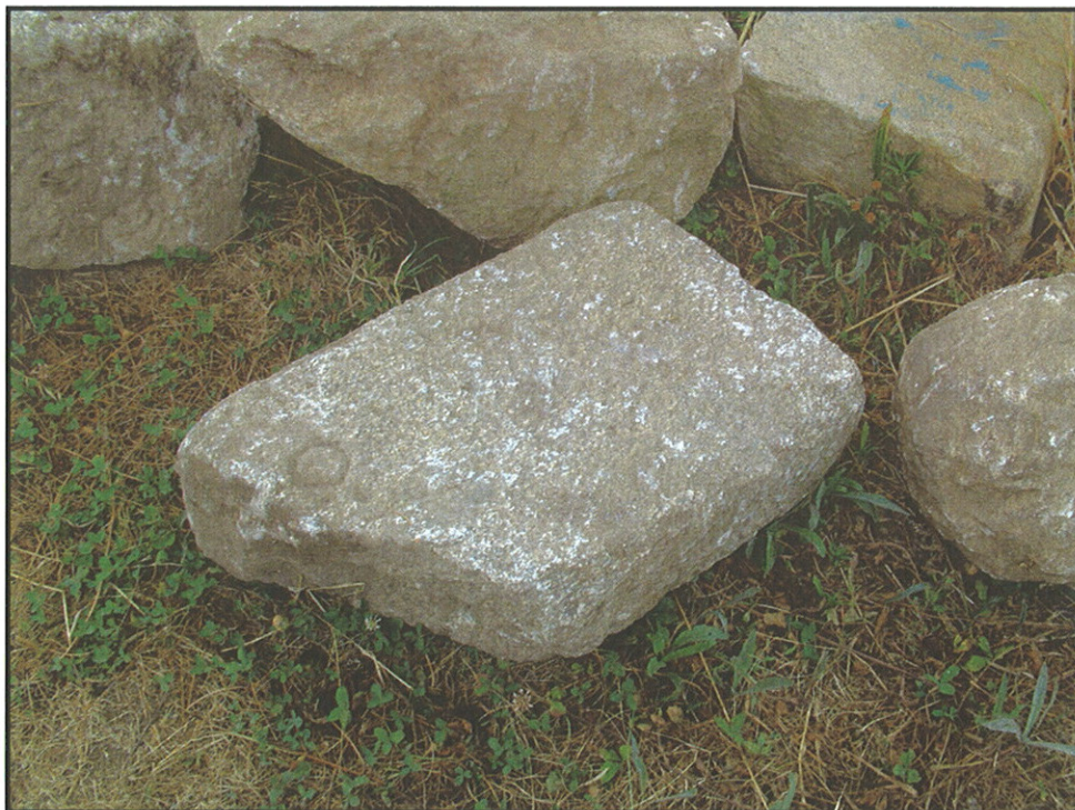
Sillar con marca de canteiro circular.
